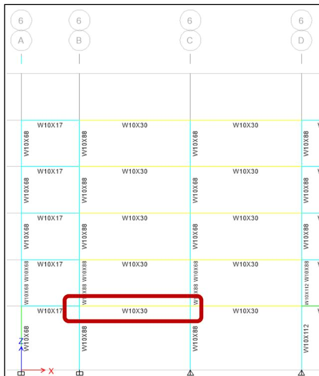
Figura 88. Ubicación de viga diseñada en elevación.
