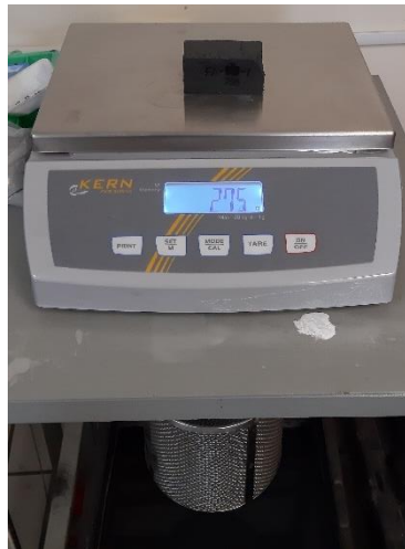
Figura 26. Obtención de la masa saturada superficialmente seca después de ser hervido y de la masa sumergida.
