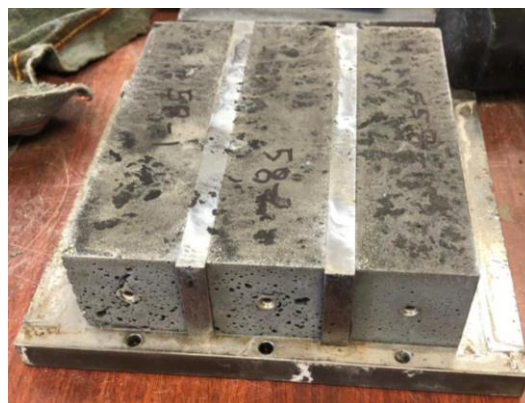
Figura 27. Desmolde de piezas de geopolímero con tuerca embebida.
