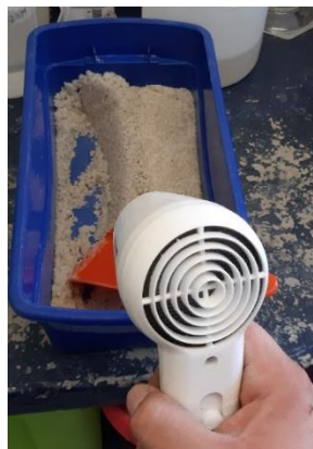
Figura 4. Secado de arena usando aire caliente.
