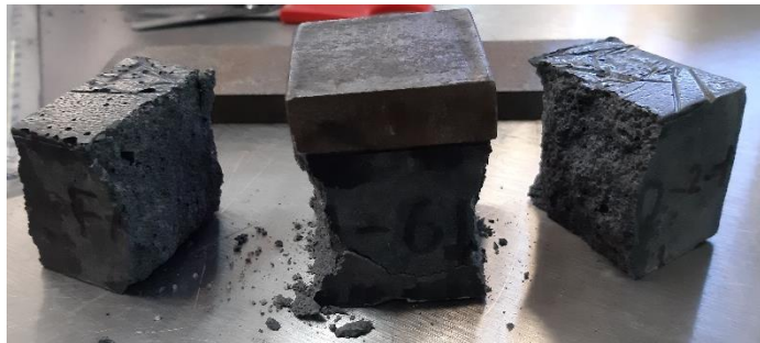
Figura 19. Modo de falla de los especímenes a compresión.
