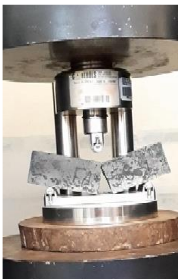
Figura 16. Falla de espécimen en prueba de resistencia a flexión.
