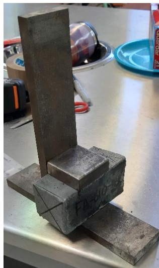
Figura 17. Alineación de las placas para prueba de resistencia a la compresión con cubos equivalente.
