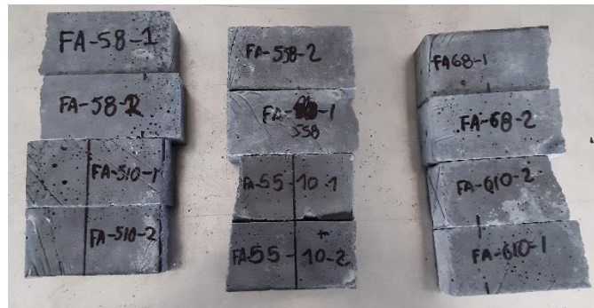
Figura 20. Trozos empleados para la determinación de densidad, porcentaje absorción y volumen de vacíos.
