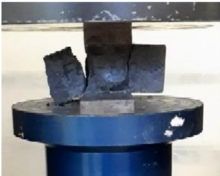
Figura 19. Modo de falla de los especímenes a compresión.
