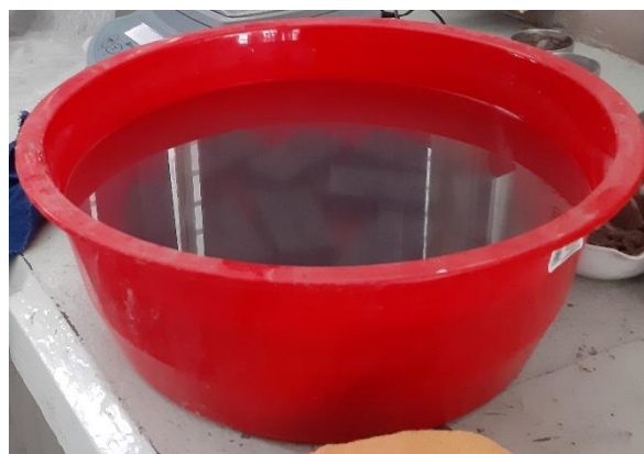
Figura 23. Recipientes con especímenes sumergidos en agua potable a 21°C durante 48 horas.
