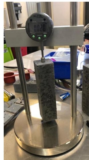
Figura 29. Medición del cambio de longitud, respecto a la longitud de calibración.
