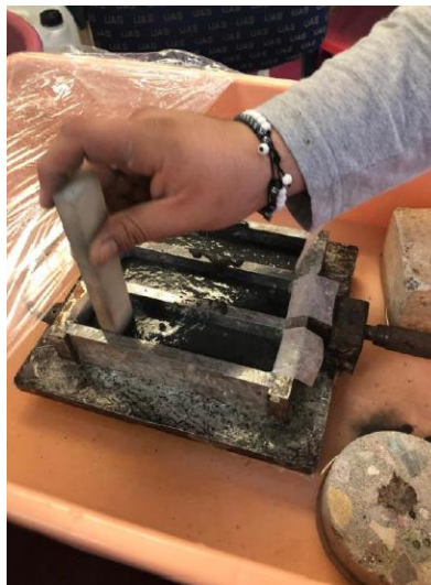
Figura 8. Colado y compactado de la mezcla.
