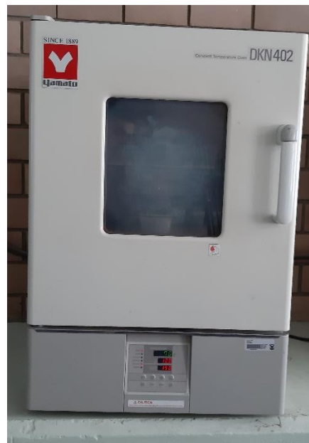
Figura 21. Horno eléctrico utilizado para secar las los trozos de viga de geopolímero.
