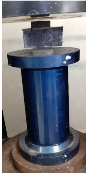
Figura 18. Configuración para ensayo de resistencia a la compresión.
