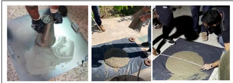
FIGURA 34. ENSAYO DE EXTENSIÓN DE FLUJO (EXPANSIÓN DE LA MEZCLA).
