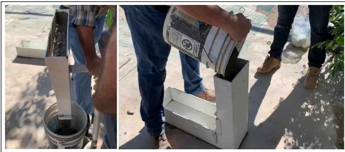
*FIGURA 61. FLUJO DEL CONCRETO A TRAVÉS DEL EMBUDO EN V Y LLENADO DE CAJA EN L, EN LA FASE EXPERIMENTAL.*
