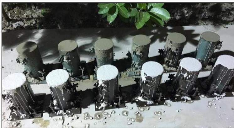
FIGURA 36. PROBETAS DE CAC DE REFERENCIA FABRICADAS CON CPO (BLANCO) Y CPC (GRIS).
