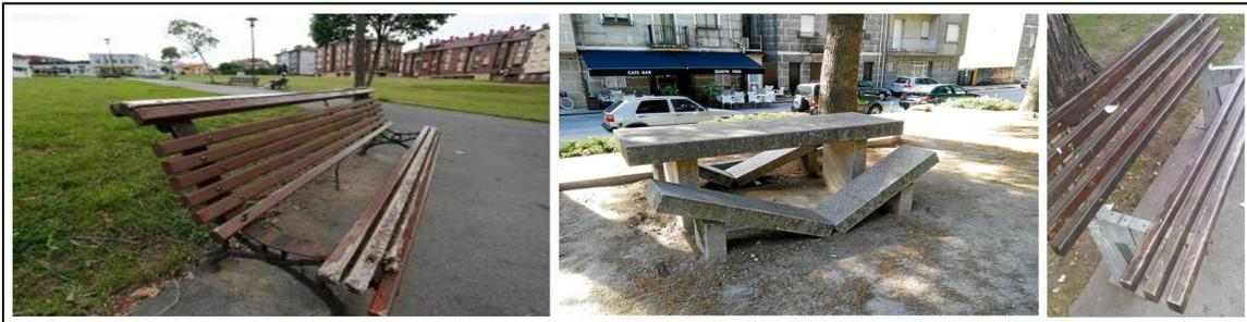
FIGURA 1. PRINCIPALES DAÑOS EN EL MOBILIARIO CONVENCIONAL, FABRICADO DE MADERA, ALUMINIO Y CONCRETO.
