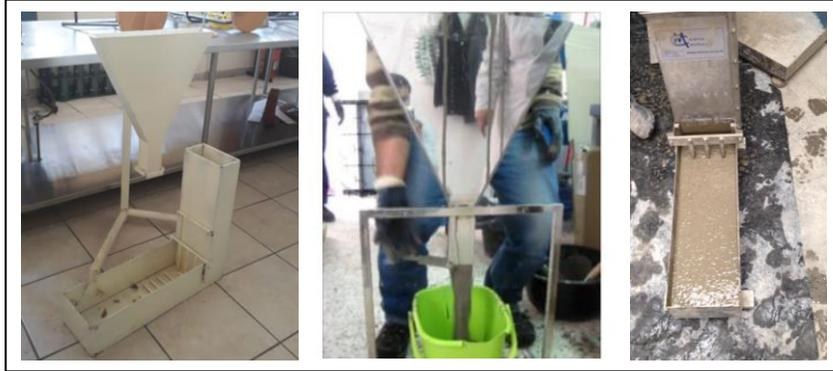
FIGURA 35. EQUIPO UTILIZADO PARA LOS ENSAYOS EN ESTADO FRESCO DE LA FASE EXPERIMENTAL (CAJA EN L Y EMBUDO EN V).
