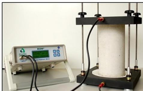
*FIGURA 20. ENSAYO DE RESISTIVIDAD ELÉCTRICA A UN ESPÉCIMEN DE CONCRETO.*
