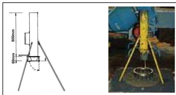
FIGURA 19. APARATO DEL ENSAYO DE ORIMET.
