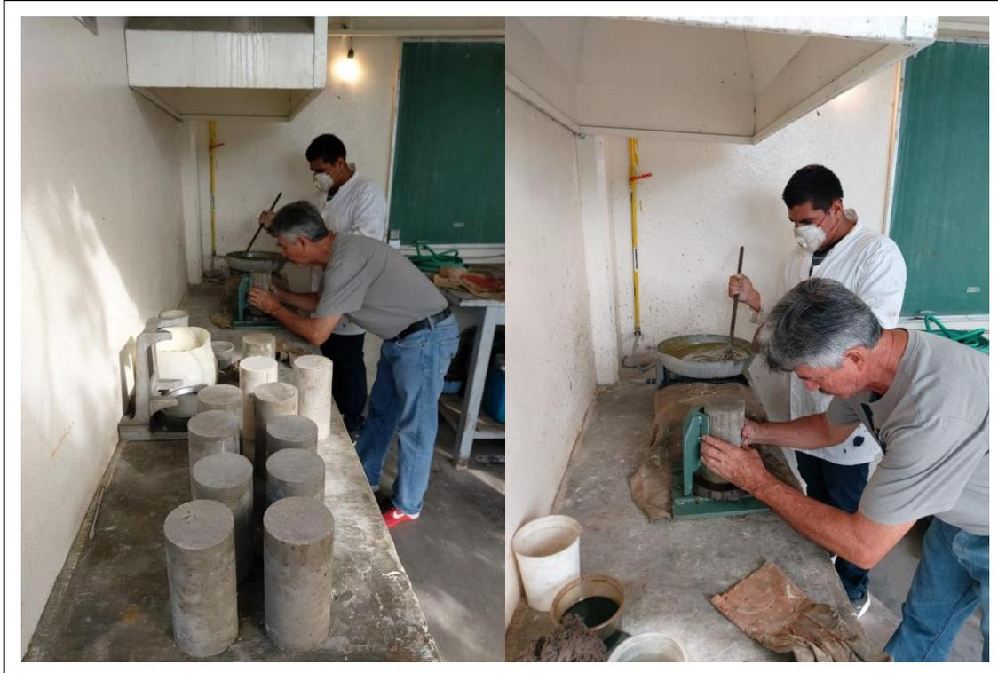
FIGURA 37. CABECEO DE PROBETAS MEDIANTE MORTERO DE AZUFRE PARA REALIZAR EL ENSAYO DE RESISTENCIA A LA COMPRESIÓN, DE ACUERDO A LA NORMA ASTM C617.
