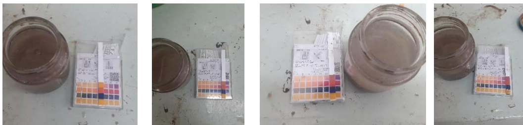
Figura 5 Medición de pH en el método de Eades y Grim.
