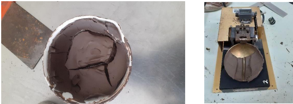
Figura 6 Límite líquido de la arcilla
