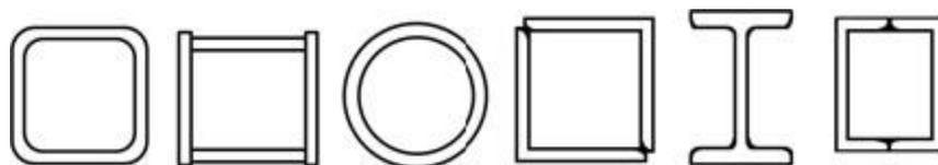
**Figura 3.** Secciones transversales de contravientos (Uso de contraviento de acero, 2015)
