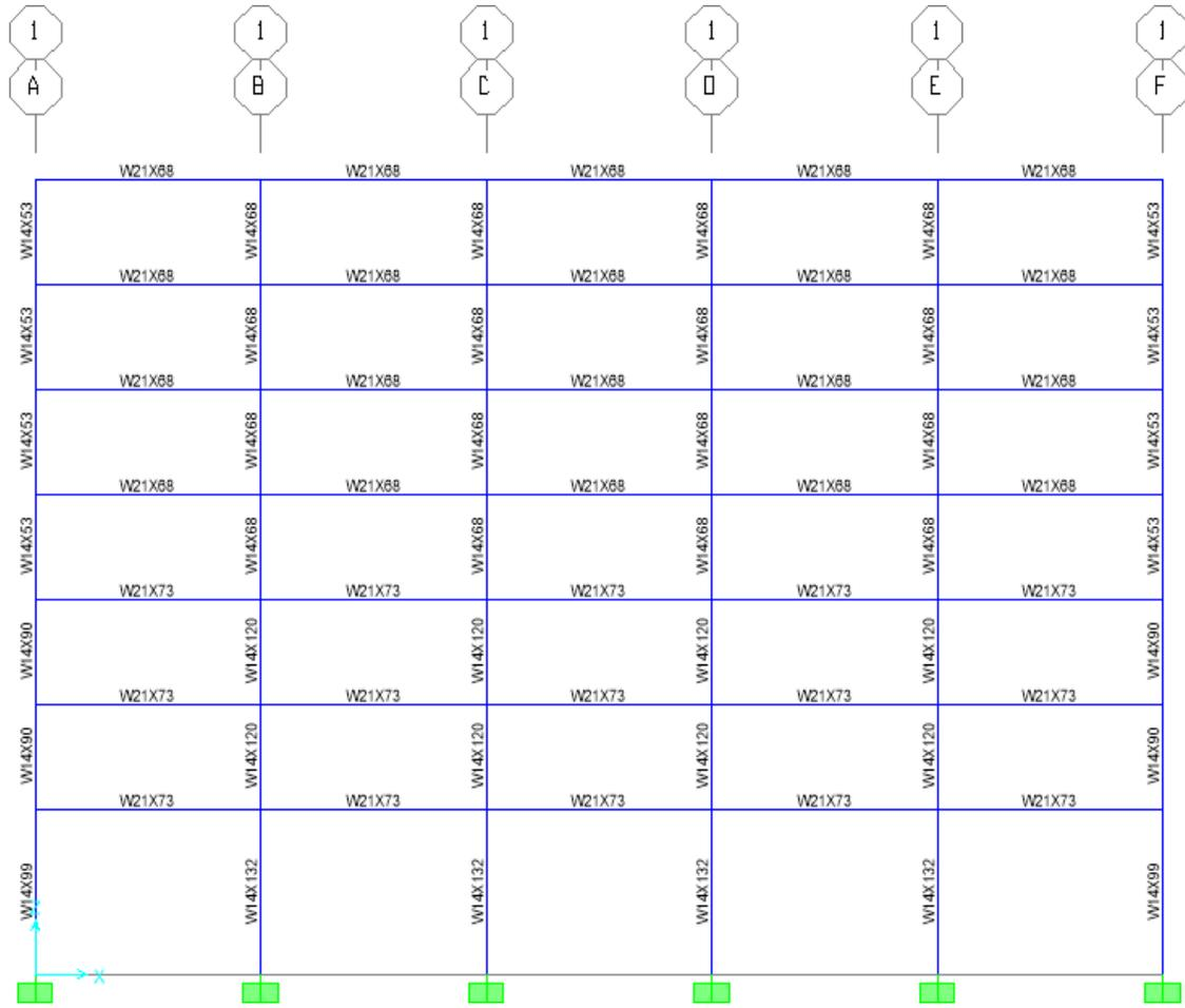
**Figura 16** Secciones de Marco Resistente a Momento
