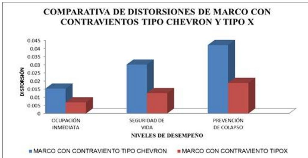
**Figura 229** Comparativa de distorsiones de marco con contravientos tipo Chevrón y tipo X
