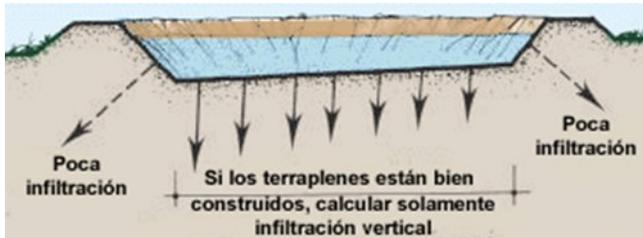
Si los terraplenes de su estanque están bien contruidos y mantenidos y su sistema de desagüe es impermeable, la cantidad de agua perdida por infiltración horizontal será muy pequeña. Sólo tendrá que calcular la infiltración vertical.
